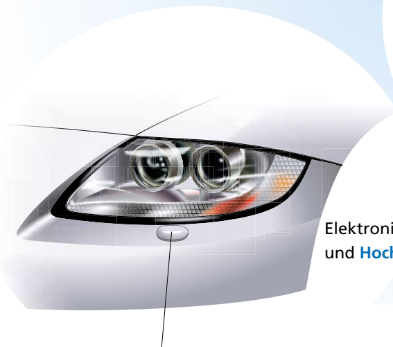
Komplexes optisches System mit automatischer Niveauregelung und Reinigungsanlage
